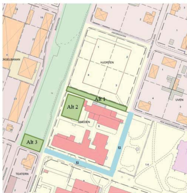
Karta ur dagvattenutredning kv Hjorten, ATAB 180228. Blå linje visar förslag till ny ledningsdragning för att ersätta västra delen av Per Anderssons gata.
